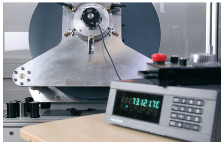
Система калибровки угла поворота для систем прямого и косвенного измерения.
