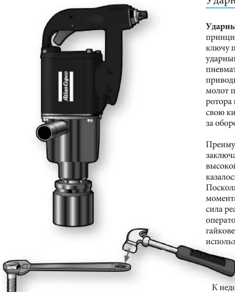
Принцип действия ударного инструмента.
