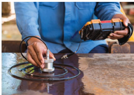
Ультразвуковой контроль стальной пластины на предмет наличия дефектов
