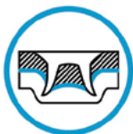
Соединение при помощи самопрони- кающих заклепок
