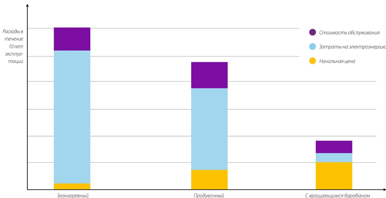
Безнагревный осушитель с адсорбентом является наиболее дорогим в эксплуатации, 15–20% его номинальной производительности расходуется на подачу продувочного воздуха. Применение осушителей с вращающимся барабаном способствует существенному сокращению энергозатрат благодаря их уникальной конструкции и системе управления. Даже по сравнению с продувочными осушителями осушители с вращающимся барабаном позволяют снизить эксплуатационные затраты в течение всего срока службы до 50%.
